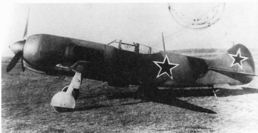
Завод №21 часто допускал искажение формы камуфляжных пятен. Сверху и снизу: Улучшенный самолет Ла-5Ф №39210109, построенный в августе 1943г. Маслорадиатор установлен под фюзеляжем между 3 и 5 шпангоутом. Фонарь кабины вместо подвижной имеет откидную (в правую сторону) часть.
