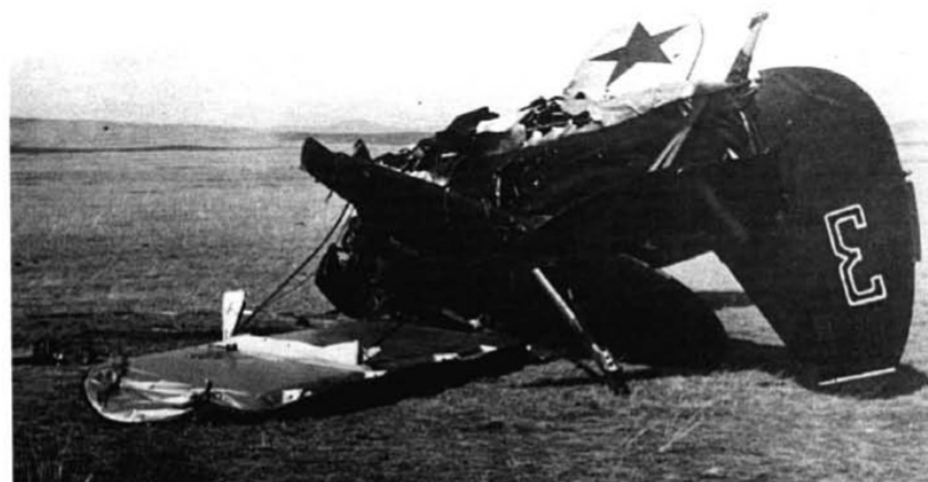
На фотографии обломков этого И-15бис хорошо заметен блеск нижней поверхности крыла, окрашенной аэролаком алюминиевого цвета. Верхние поверхности — зеленые. Самолет (зав. №3826, выпущен 22.04.38 г.) 3-й эскадр. 70 ИАП потерпел аварию 27.04.39 г. южнее Улан-Батора (Монголия). Летчик л-т Рыбаков А.П. РГВА.
