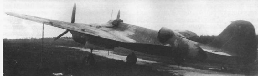
Трехцветный камуфляж (серый + зеленый 4БО + темно-коричневый) самолета СБ (эскиз № 6). РГВА
