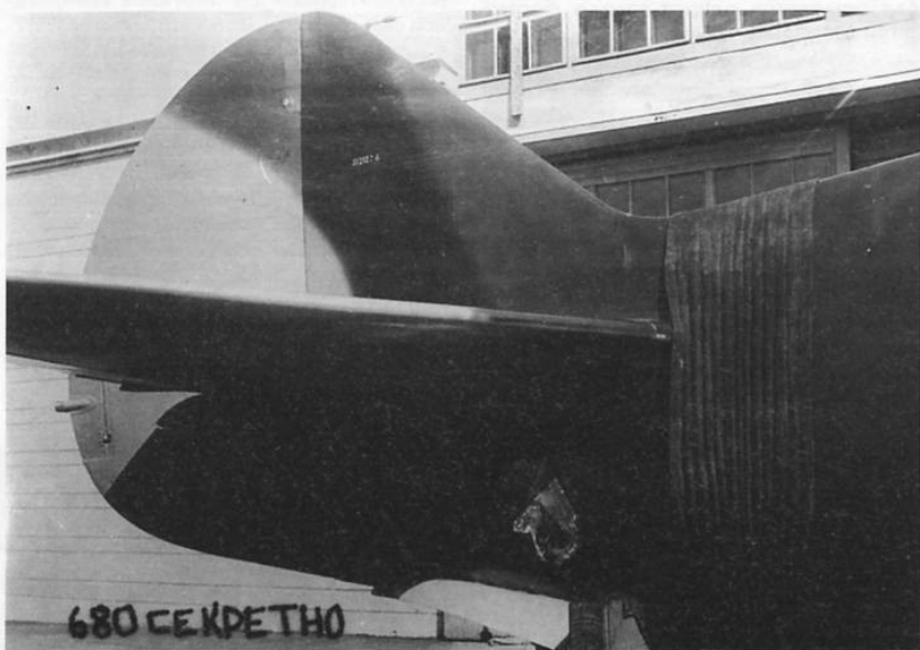
ЛаГГ-3 зав.№ 3121376, выпущенный заводом №21 10 июня 1941 г. Один из 28 ЛаГГов, имевших многоцветный камуфляж. На фото видны камуфляжные пятна трех цветов: песчаного, черного и зеленого (слева направо). Самолет потерпел аварию 14 июня 1941 г. Из-за флаттера хвостового оперения балансир руля пробил фюзеляж.
